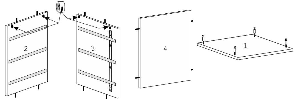
6. Соединить детали 2 и 3 с деталями 4 и 1, затянуть эксцентрики А по часовой стрелке до упора.
