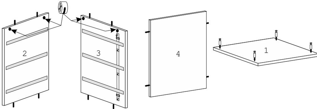
6. Соединить детали 2 и 3 с деталями 4 и 1, затянуть эксцентрики А по часовой стрелке до упора.
